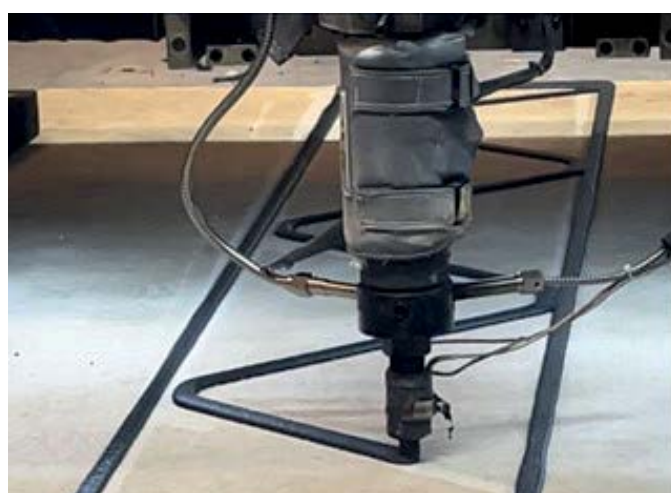
Un imprimante industrielle grand format qui dépose le matériau couche par couche.
